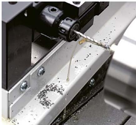
Foratura profonda con punte con fori di lubrificazione. I trucioli prodotti vengono espulsi lungo i taglienti della punta, impedendone l'intasamento.
